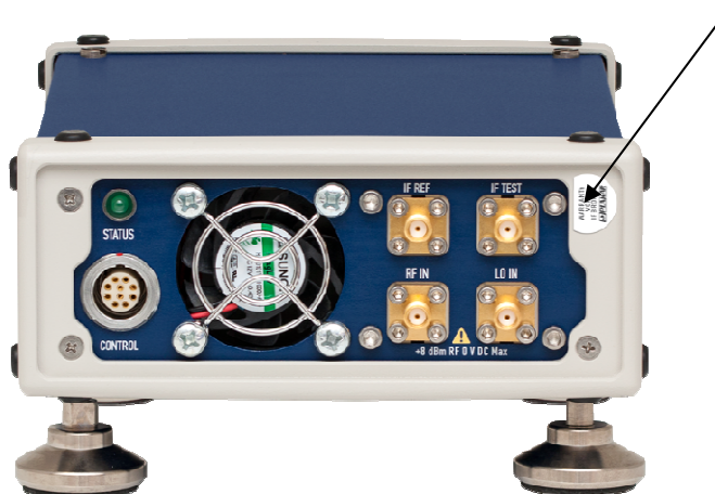
Рисунок 3 – Схема пломбировки от несанкционированного доступа
